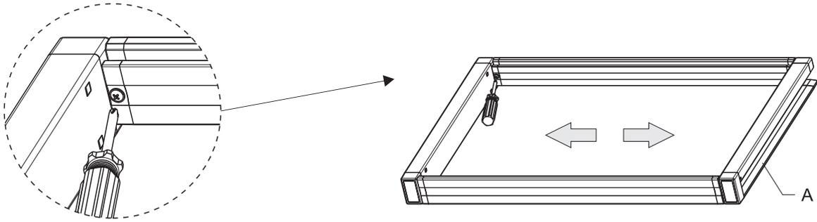
3 Установите раму на направляющие и зафиксируйте ее с помощью винтов G.
