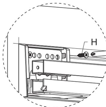
2 Соберите раму, как показано на рисунке. Используйте винты для регулировки рамы по ширине.
