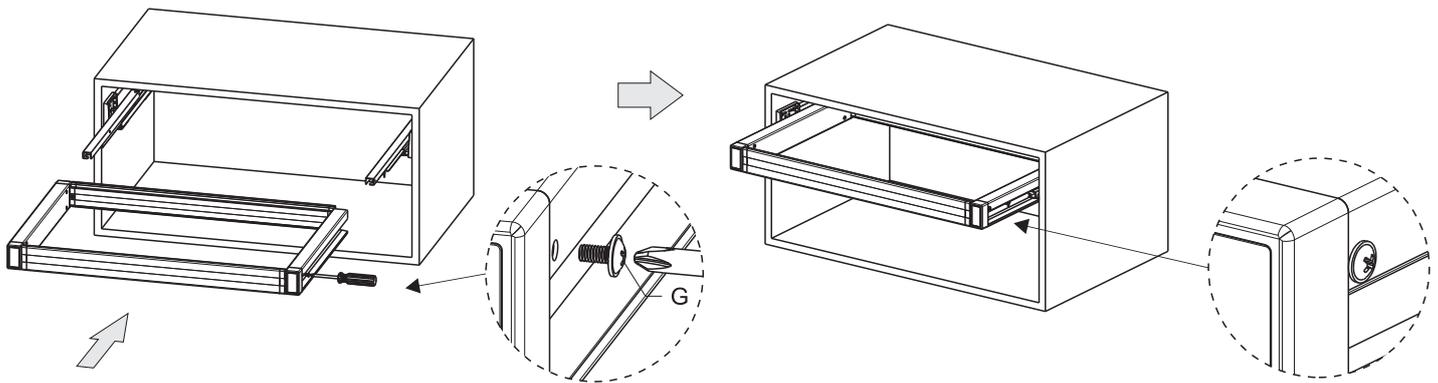
4 Закройте крепление направляющих с помощью заглушек F.
