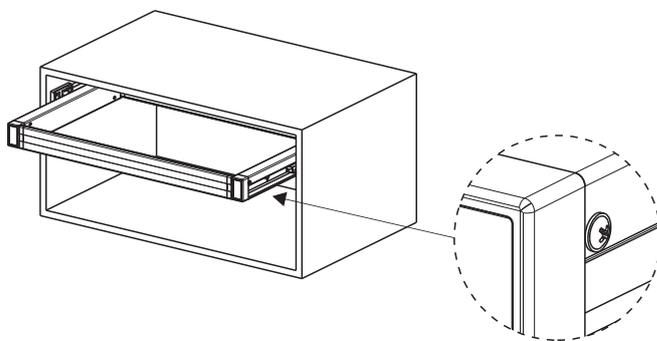
5 Закройте крепление направляющих с помощью заглушек F.
