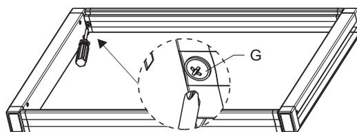
4 Установите раму на направляющие и зафиксируйте ее с помощью винтов.
