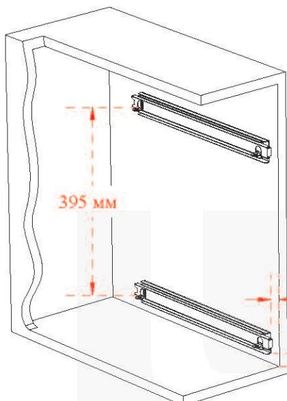
1. Сначала отсоедините внутренние направляющие ползуна, закрепите внешние направляющие винтом на внутренней поверхности шкафа согласно размерам, приведенным на рисунке.
