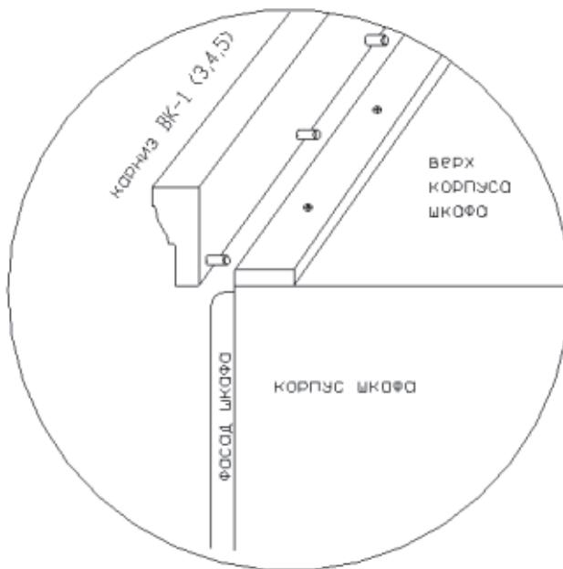
Карниз крепится с помощью эксцентриковых стяжек или шурупов на крайние боковые микров. которые выступают над верхом на высоту карниза.
