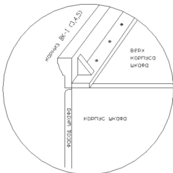
Рейка (с торцевыми отверстиями под шканты) крепится на верх корпусов шкафов шурупами, затем устанавливается карниз с помощью шкантов
