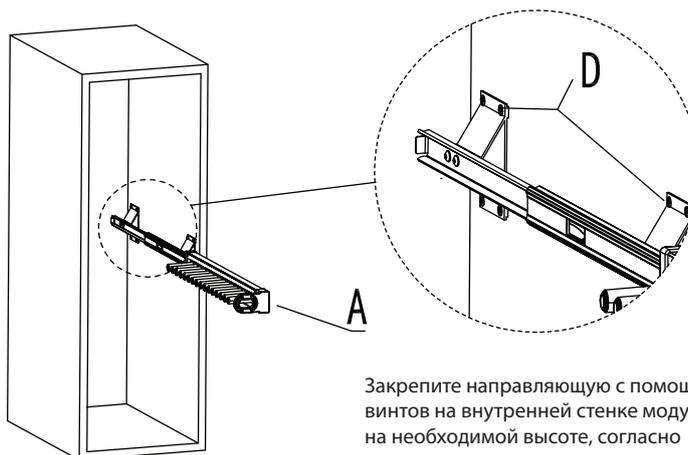
Закрепите направляющую с помощью винтов на внутренней стенке модуля на необходимой высоте, согласно схеме присадки.
